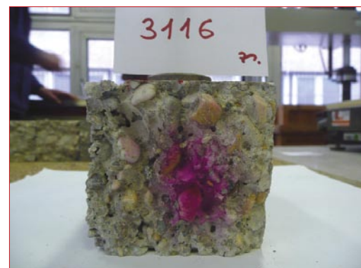
Szárazon tárolt kocka (felső kép) és nedvesen tárolt kocka (alsó kép) karbonátosodása. Víz/cement tényező 1,0.
