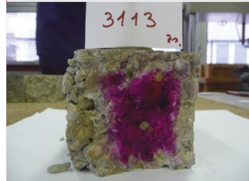
Szárazon tárolt kocka (felső kép) és nedvesen tárolt kocka (alsó kép) karbonátosodása. Víz/cement tényező 1,0.
