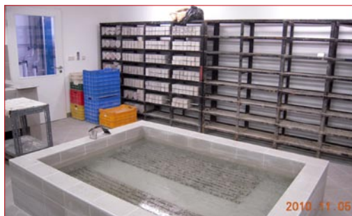
A „kádszoba” már várja a betonmintákat
