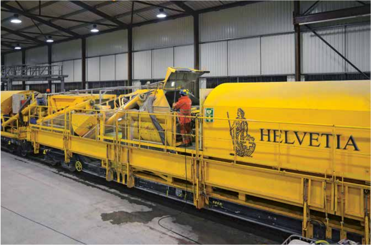
16. ábra: A betonozó vonat a vágánycsarnokban – anyagátrakó-hely és karbantartó-javitó műhely © TTG
