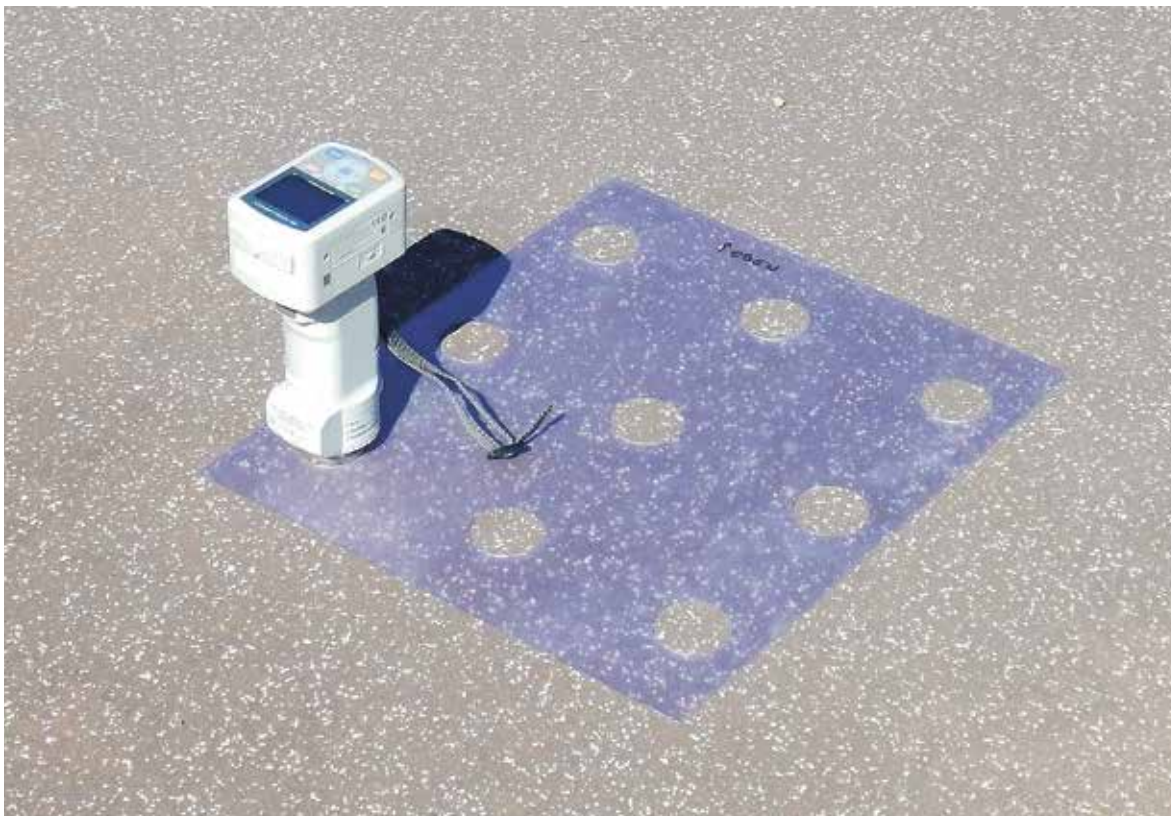
10. ábra: Méréselrendezés a reflexió (visszaverődés) megállapításához
