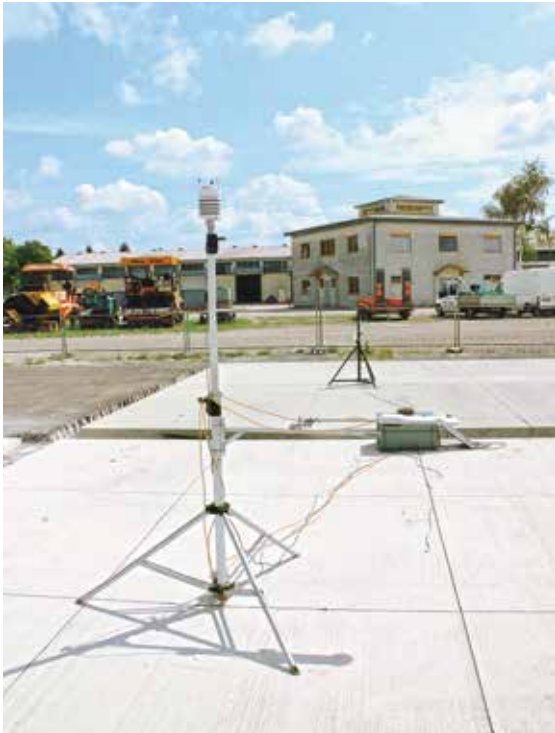
11. ábra: Sugárzási mérleg, a hőmérséklet-, a szélsébség- és széliránymérésekre szolgáló berendezés
