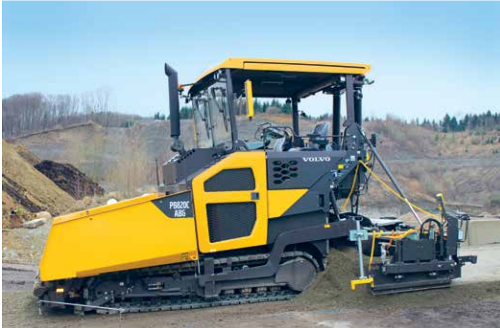
Volvo lánctalpas finiser kettős vibrogerendával
