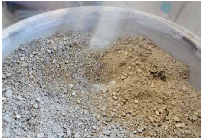
Földnedves betonkeverék a laboratóriumban
