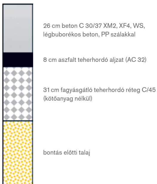
A Daimler-csomópont általános rétegrövidje (pályakeresztmetszet)
