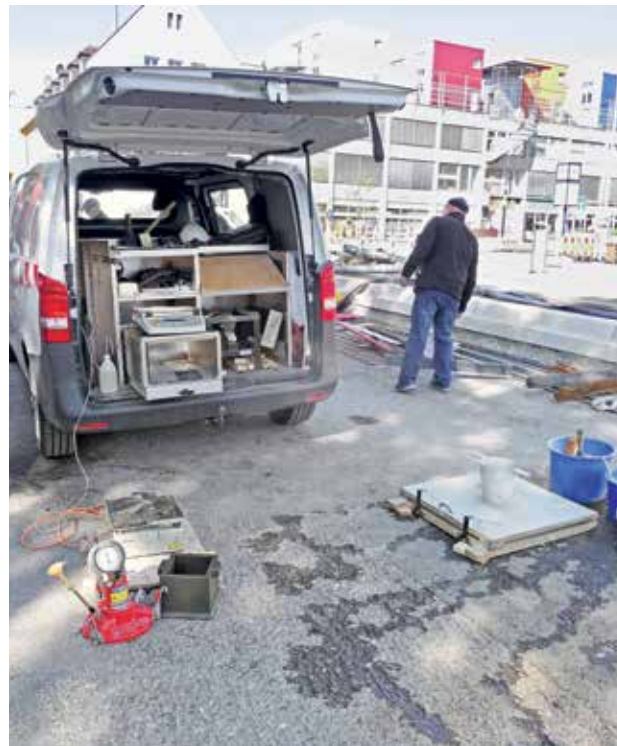
A frissbeton ellenőrzése, laborgépkocsival
